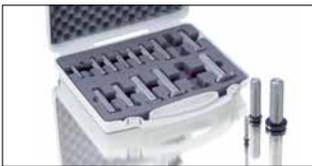
Die VOSS Vormontagestutzen in der Grundausführung zur Schneidringmontage sind enger toleriert als normale Verschraubungsstutzen und verschleißfest. Aber auch hier ist Kontrolle nötig: Der Innenkonus des Verschraubungsstutzens muss mindestens nach jeweils 50 Vormontagen auf Lehrenhaltigkeit überprüft werden. Ideal darauf abgestimmt sind die VOSS Konuslehren, einzeln oder oder als Komplett-Set für alle Größen.
