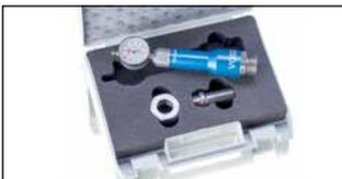
Mit der VOSS Prüflöhre wird die Qualitätskontrolle bei Schneidringvormontagen in der Serienfertigung und beim Wareneingang beschleunigt. Einfach Rohrende (6-42 mm) ansetzen, handfest anziehen, Ergebnis ablesen. Nach einer zusätzlichen optischen Überprüfung des Materialaufwurfs am Schneidring, ist die Kontrolle abgeschlossen.
